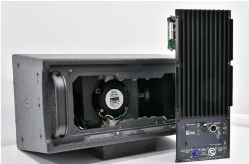
Auf der Außenseite verfügt das Elektronikmodul über Kühlrippen zur Wärmeabfuhr – die X40 kommt ohne aktive Lüftung aus
