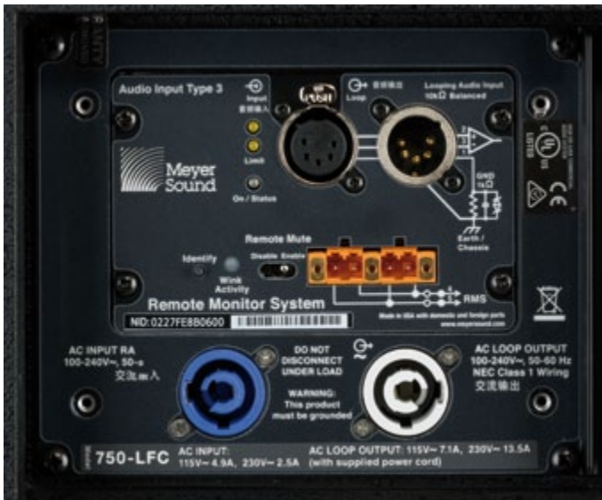
Anschlussfeld des Subwoofers mit austauschbarem Input-Modul, hier mit RMS-Funktion
